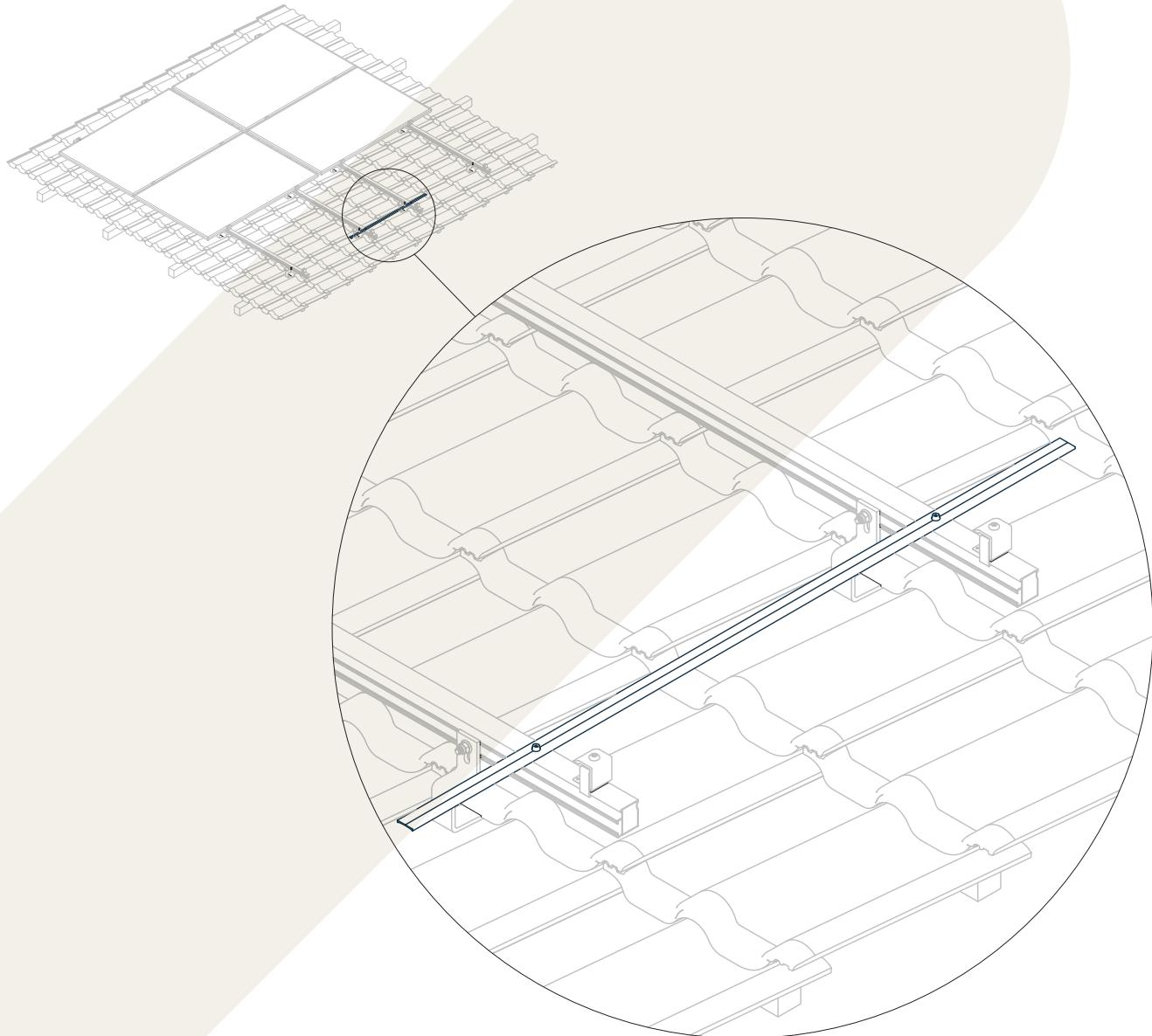
Die Systemträger können bei einlagigem Aufbau mit der sflex Aluleiste 3-27-1160 mm erdschlüssig miteinander verbunden werden. Bei Quermontage erfolgt die Verbindung zwischen den Modulspalten, bei Hochkantmontage zwischen den Modulreihen.
